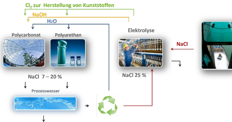
NaCl Recycling bei Covestro. Quelle: Covestro.
