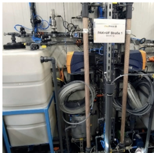
Abbildung 2: Pilotanlage Ultrafiltration: Zu sehen sind zwei halbtechnische Module (Sonderanfertigungen), ausgestattet mit der DuPont™ IntegraTec™ Multibore Membran mit je 3,2 \text{ m}^2 aktiver Membranfläche im PAK-Inline-Dosierverfahren zur Behandlung von 192 \text{ L/h} je Modul.
