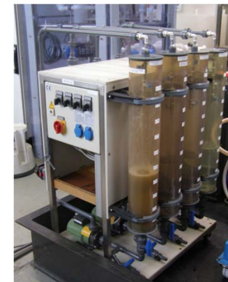
BFI Technikumsanlage zur Kühlwasserbehandlung
