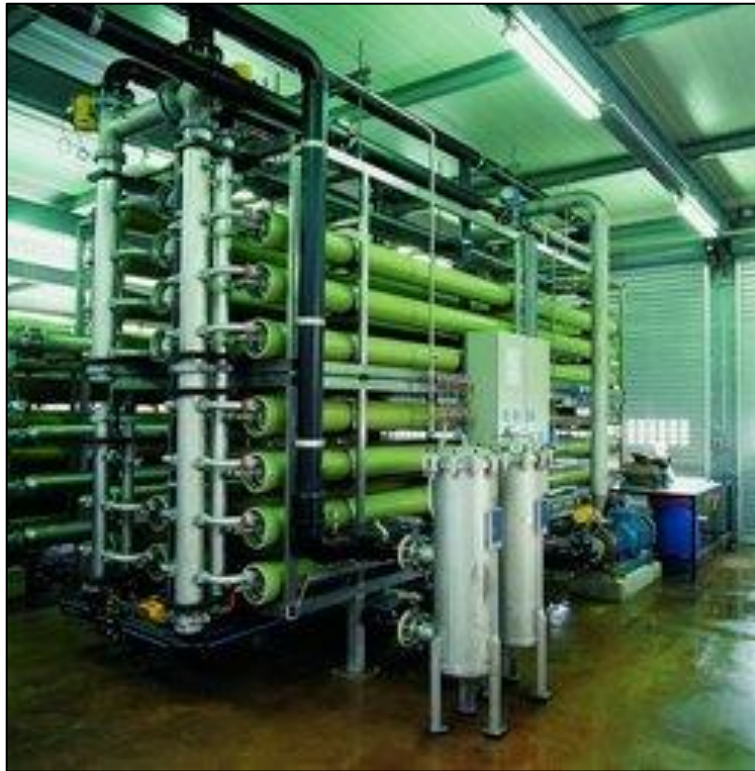
Abb. Typische Anlage – Umkehrosmose (Quelle: Karl Spiegl GmbH)
