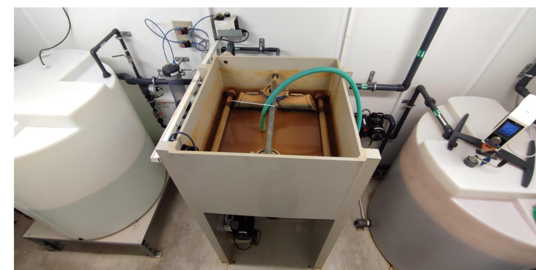
Getauchtes Keramikmembran-Modul in Filtrationstank (Quelle: DVGW-TUHH)
