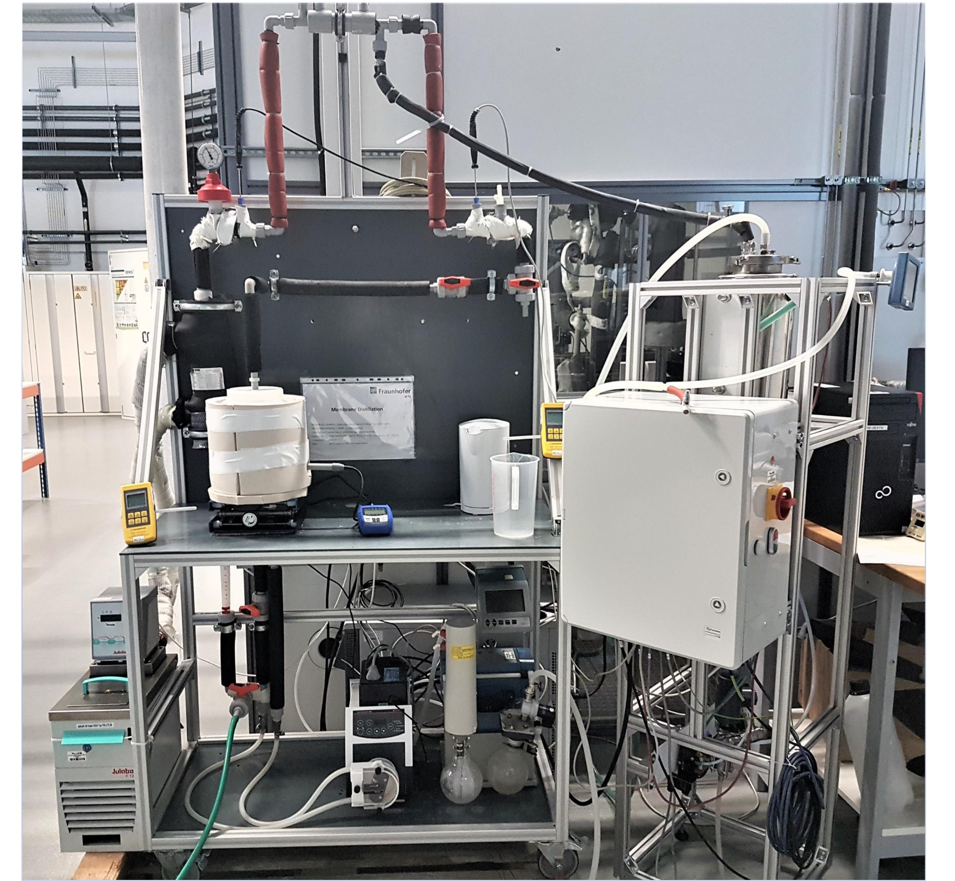
Membrandestillationsversuchsstand des IKTS im Labormaßstab.
