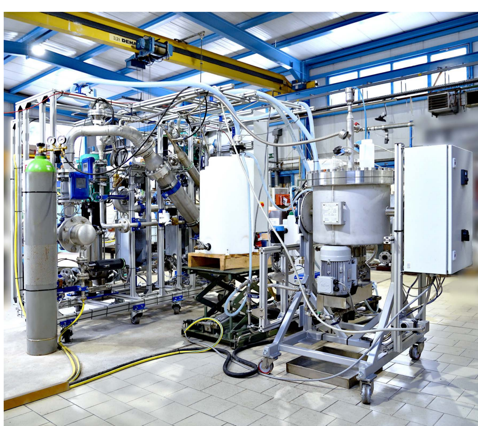
Pilotanlage mit erweitertem Mess- und Regelungssystem sowie neu entwickeltem beigestelltem Rotationsscheibenmodul (E.S.C.H.) für Filtrationsversuche mit MKR und RS mit erhöhter Membranfläche im Technikum
