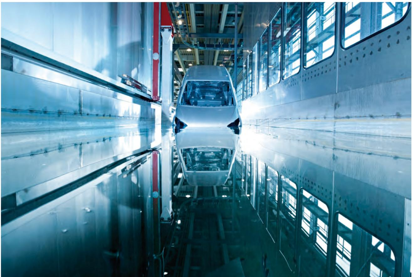
Abb. 23: Lackierung im Tauchbad: In den Wässern und Lacken können sich Bakterien leicht vermehren und die Oberflächenbeschichtung beeinträchtigen (Eisenmann Anlagenbau GmbH & Co. KG)
