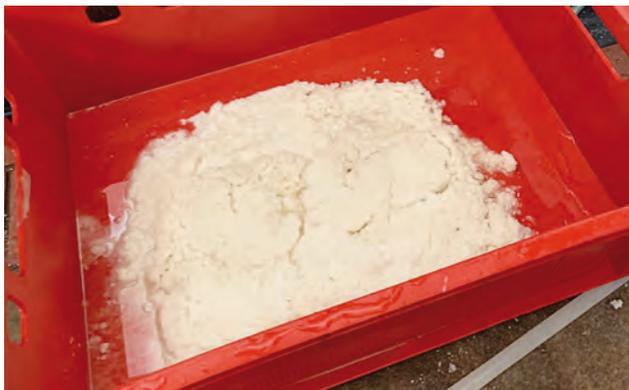
Abb. 28: Rückgewonnene Salze aus dem Produktionsabwasser der L'Oréal Produktion Deutschland GmbH & Co. nach Behandlung mit der TerraSaline S (ASL) (Quelle Terrawater GmbH)
