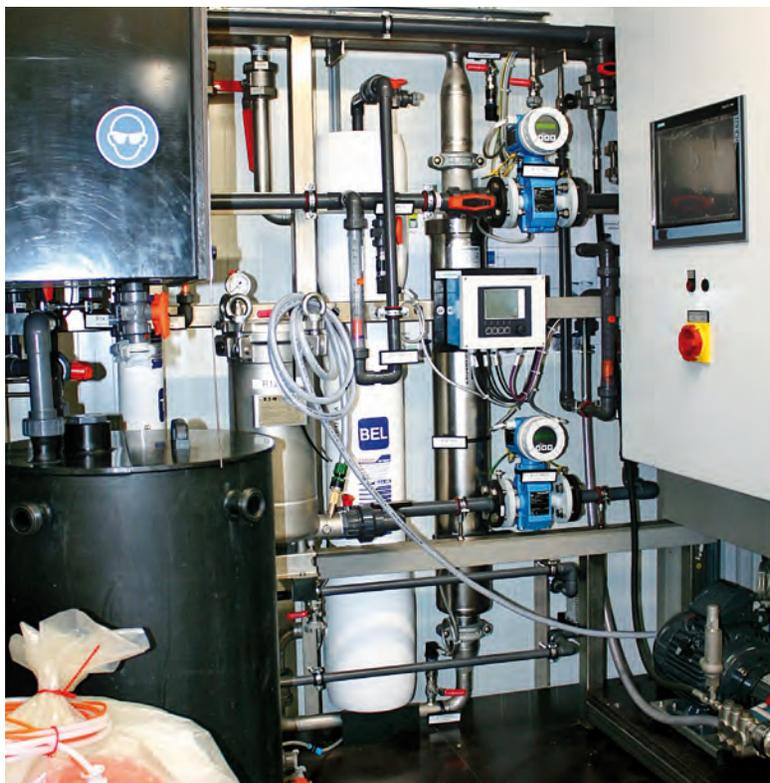
Abb. 20: Hochdruck-Umkehrosiose im Versuchscontainer
