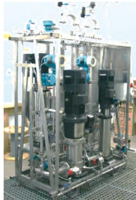
Abb. 17: Flotation+MF (akvola) + keramische NF (IKTS, Junghans) und LUM-/Sopat-Sonden
