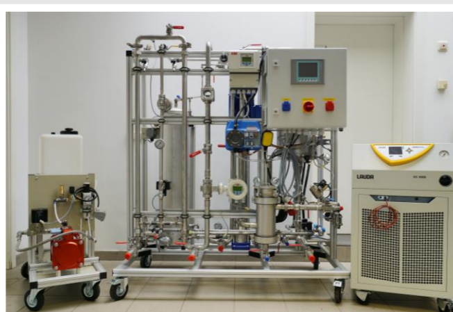
Bild 6: Mobile Versuchsanlage zur Prozesserverprobung (Mikro- bis Nanofiltration).
