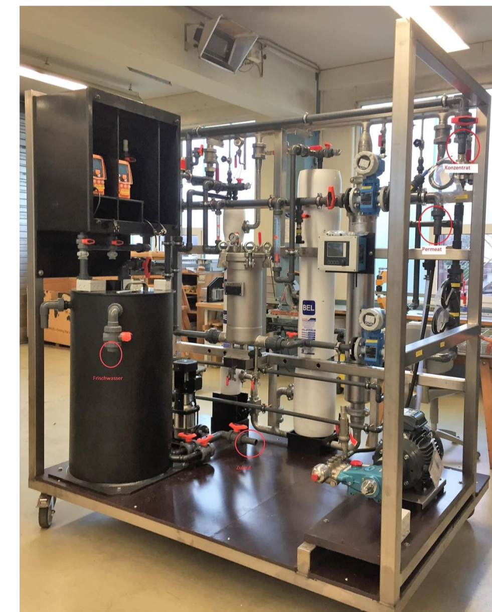
Hochdruck-Umkehrosmose Quelle: Wehrle
