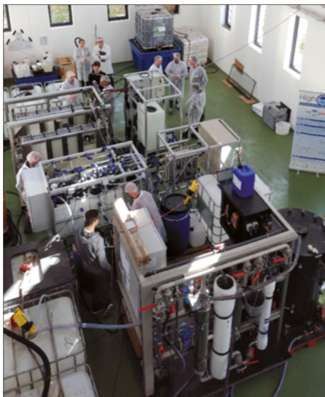
Abbildung 14: Besichtigung der HighCon Demonstrationsplattform bei der DEK Berlin durch die Projektpartner. Zu sehen sind von vorne nach hinten: Nanofiltration (Wehrle-Umwelt GmbH), Elektrodialyse (Metathese) (Deukum GmbH) und Membrandestillation (SolarSpring GmbH).
