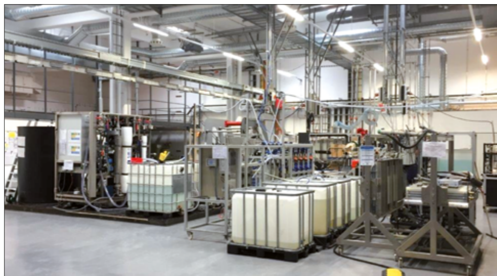
Abbildung 16: Ansicht der HighCon Demonstrationsanlagen; von links nach rechts: Nanofiltration (Wehrle-Umwelt GmbH) zur Organikabtrennung, Elektrodialyse (Metathese) (Deukum GmbH) und Membrandestillation (SolarSpring GmbH) zur Aufkonzentrierung bis kurz vor die Sättigungsgrenze.
