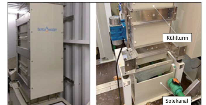
Abbildung 9: Bisher verwendeter Kühlturm über dem Setzbecken (links) und neuer Rüttelkühlturm in der Technikumsanlage (rechts).
