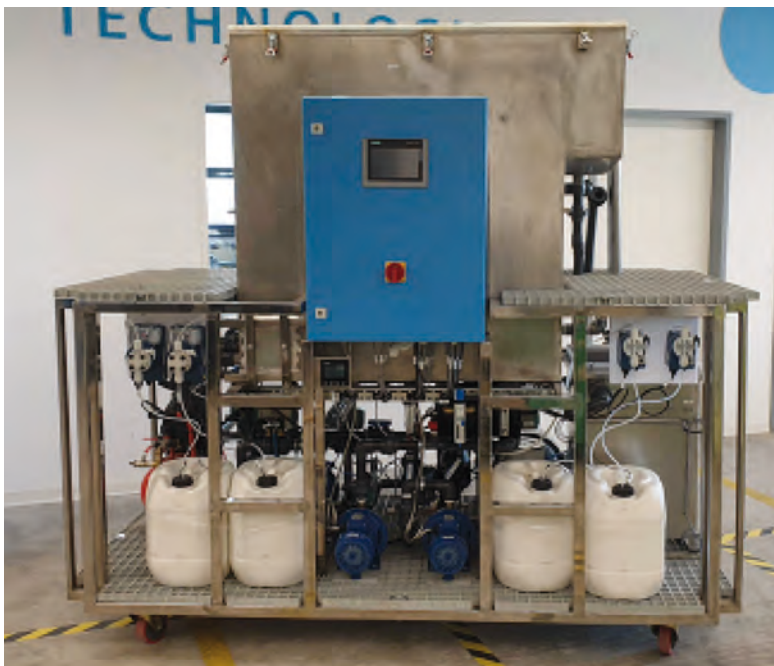
Abb. 17: Flotation+MF (akvola) + keramische NF (IKTS, Junghans) und LUM-/Sopat-Sonden
