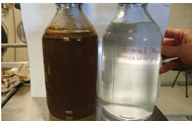
Abb. 18: Sichtproben vom 26.09.2019: links LaWa Zulauf, rechts Membranpermeat
