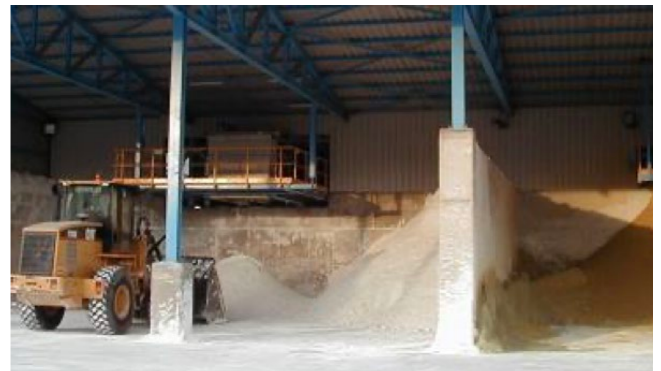
Abbildung 6. Lager der Reststoffe aus der fraktionierten Fällung mittels Kalkmilch aus der Waschsäurebehandlung der Kupferhütte Atlantic Copper – links der Sekundärrohstoff technischer Gips, rechts der arsenkontaminierte Abfallgips (Quelle: A. Ante)
