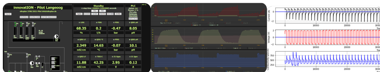
Abbildung 4: Webbasierte grafische Bedienung des Mess- und Steuerungssystems der Pilot- und Laboranlagen inkl. Trends. Erweiterte Auswertungen mit Python (v.l.n.r.) [Staiger, elkoplan & Rosentreter TUD].
