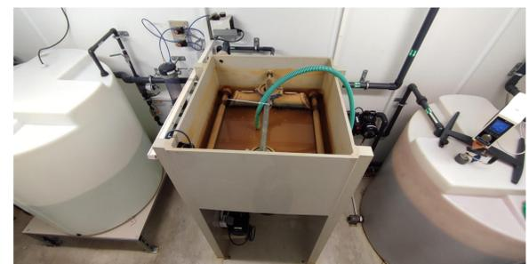
Getauchtes Keramikmembran-Modul im Filtrationstank (Quelle: DVGW-TUHH)
