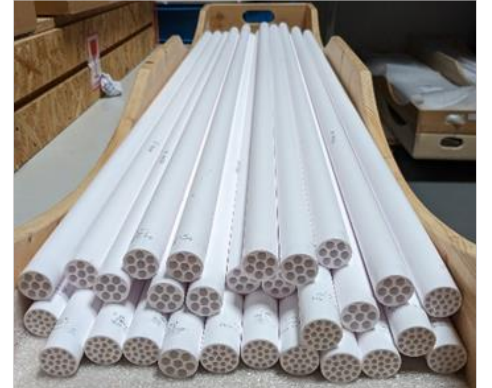
Hydrophobe keramische Membranrohre des IKTS mit einer Länge von 1,2 Metern.
