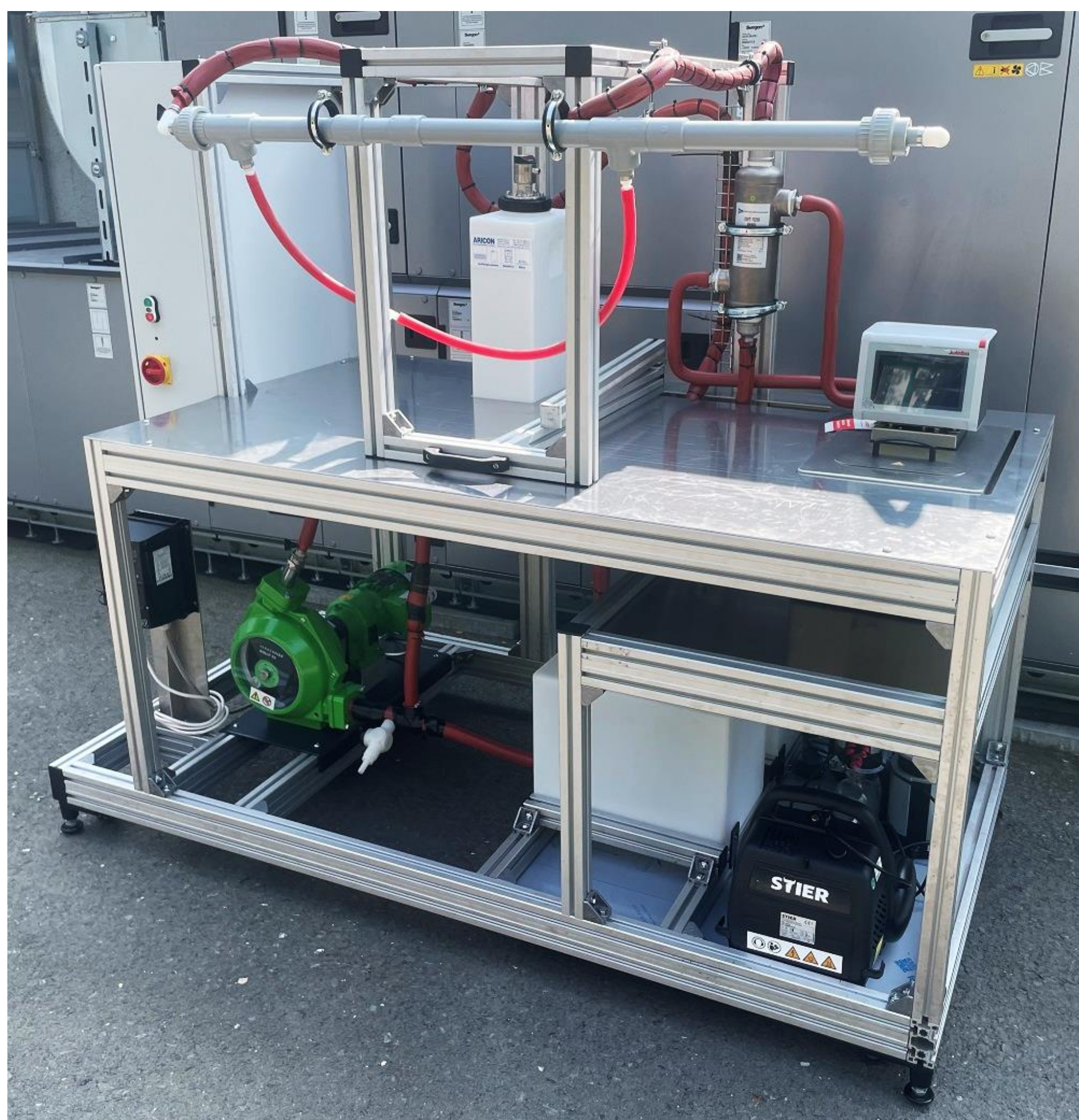
Anlagenteil Membrandestillation für die Pilotanlage, Foto: IKTS 2024
