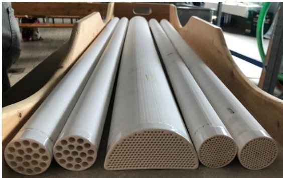
Verwendete Geometrien für RS und Membranträger hoher Fläche
