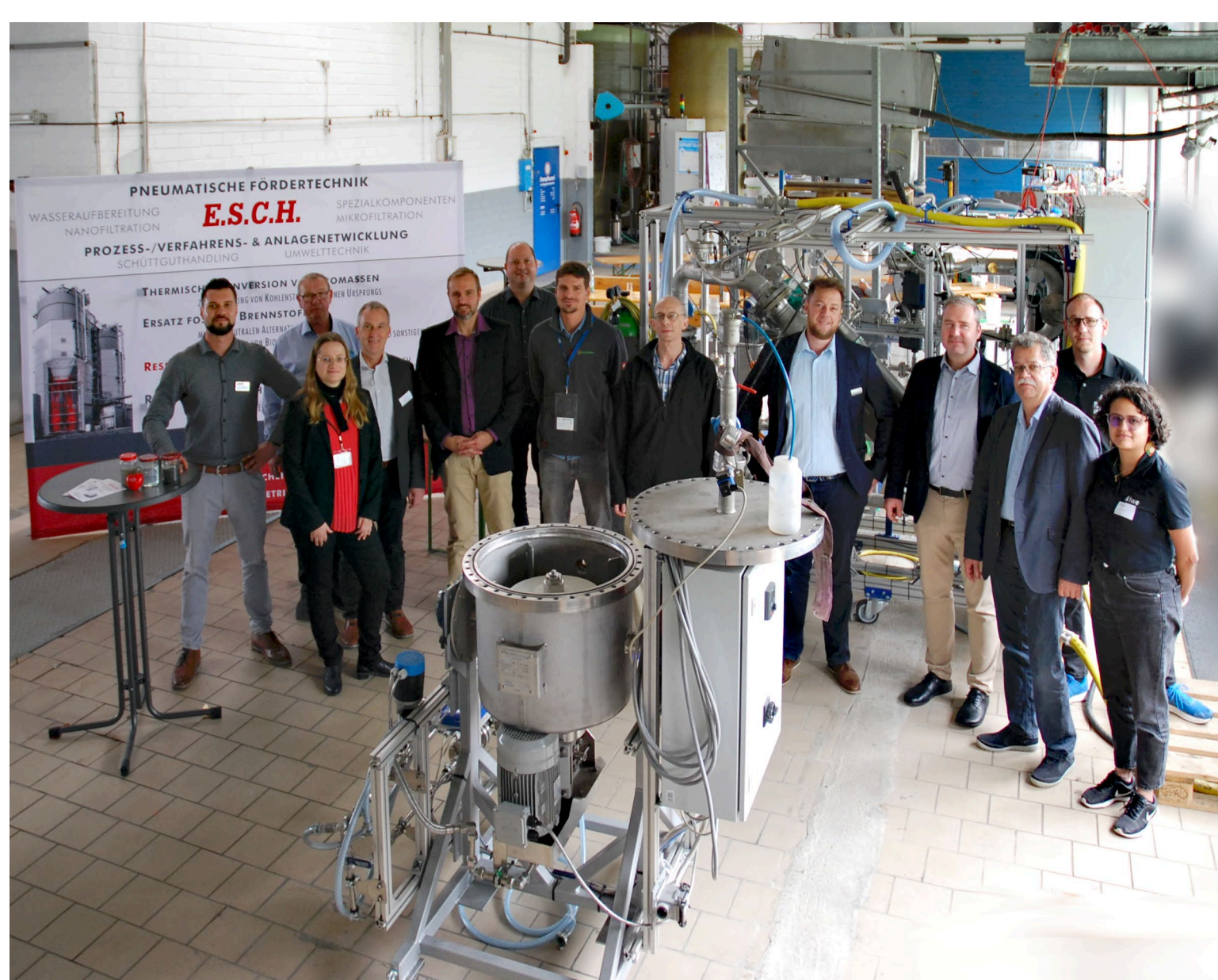
Pilotanlage mit erweitertem Mess- und Regelungssystem sowie neu entwickeltem beigestelltem Rotationsscheibenmodul (E.S.C.H.) für Filtrationsversuche mit MKR und RS mit erhöhter Membranfläche
