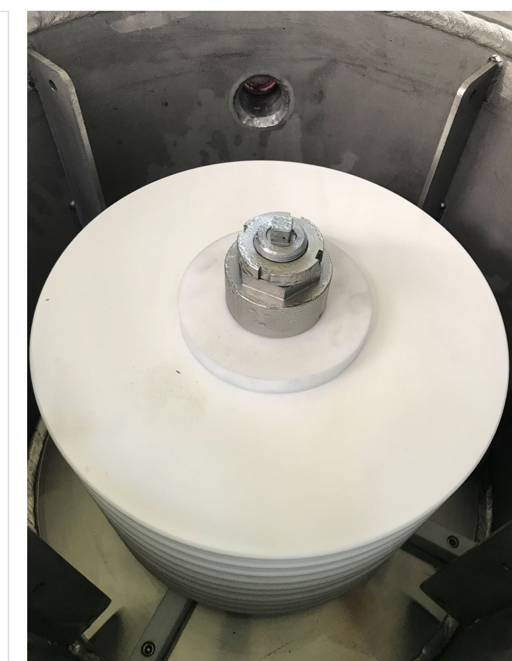
Modul für 10 Rotationsscheiben mit Durchmesser 312 mm
