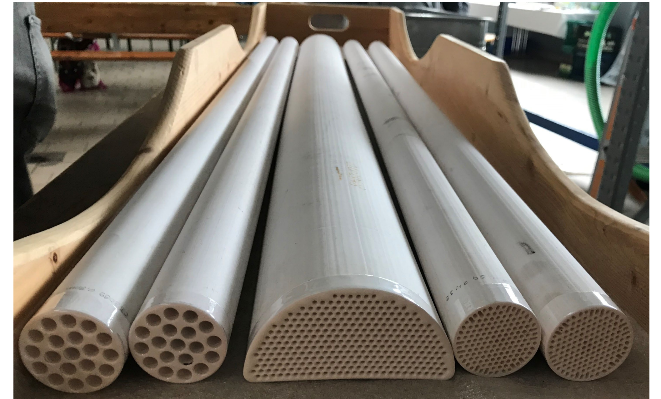
Verschiedene Rohrgeometrien (von links nach rechts): CB - 19K-D41, Halb - 311K-D100, NA - 151K-D41.
