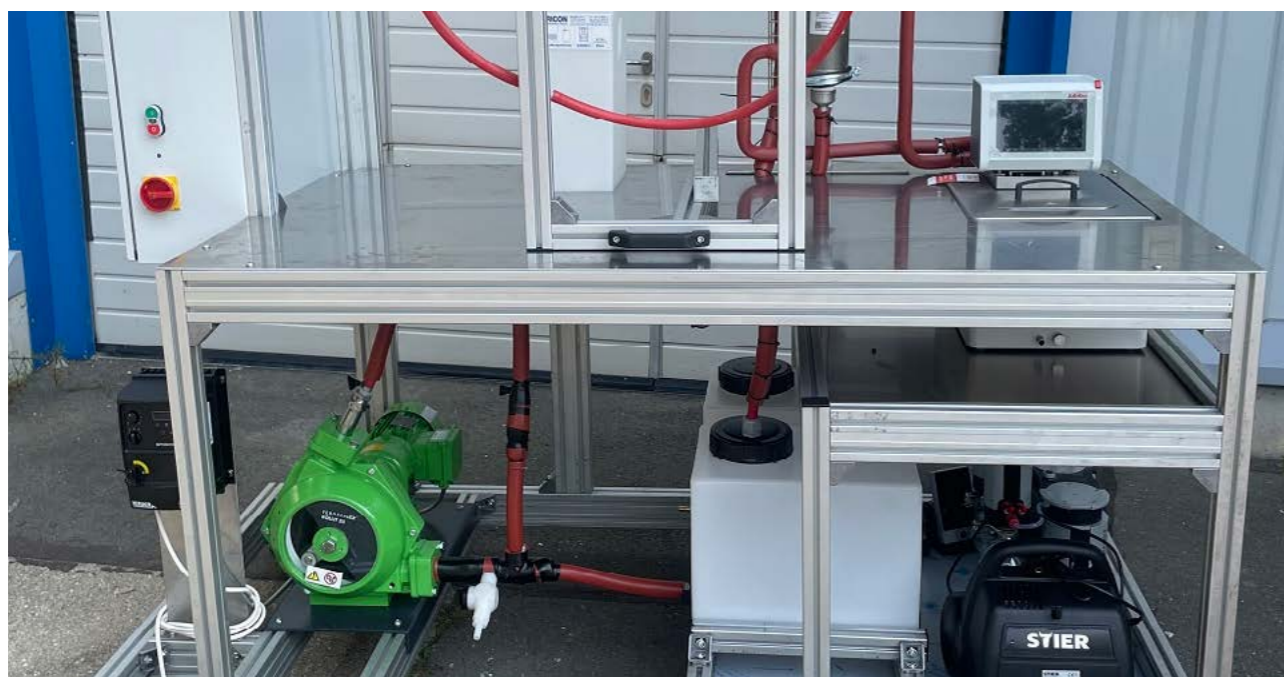
Membranseitiger Anlagenteil zur Erprobung der Verfahrenskombination aus keramischer Membrandestillation und Kristallisation (Quelle: Fraunhofer IKTS)
