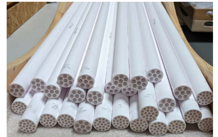
Keramische 7-Kanal- und 19-Kanal-Rohre für die Membrandestillation (Quelle: Fraunhofer IKTS)
