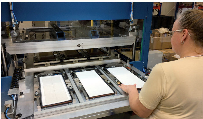
Erste erfolgreiche Siegelversuche mit bedruckten Membranen in der Produktionslinie (Foto: MARTIN Membrane Systems AG)
