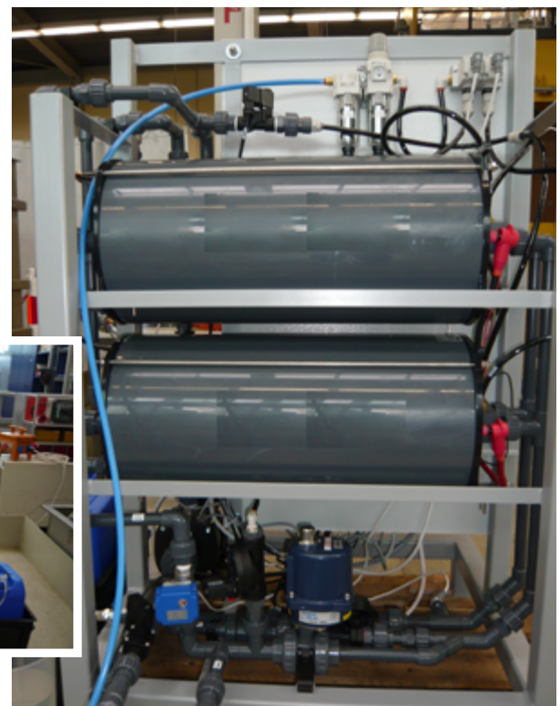
Pilotanlage: Kapazitive Deionisation (CDI) im Technikum des BFI (Foto: BFI)
