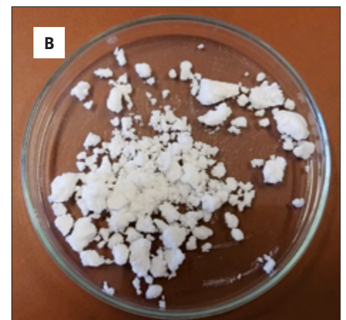
Abb. 9: A. Proben aus der Umkehrosmose (UO) am Standort der DEK Berlin, Zulauf (links), Permeat (mitte), Konzentrat (rechts); B. Rückgewonnenes Salz aus dem UO-Konzentrat nach der Kristallisation am Ende der Konzentratbehandlung (Fotos: TU Berlin)
