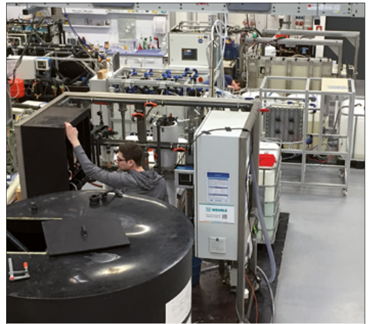
Abb. 8: Ansicht der HighCon Demonstrationsplattform beim Fraunhofer ISE, Freiburg. Zu sehen sind die folgenden Technologien (von vorne nach hinten): NF, EDM, MD (Fotos: TU Berlin)
