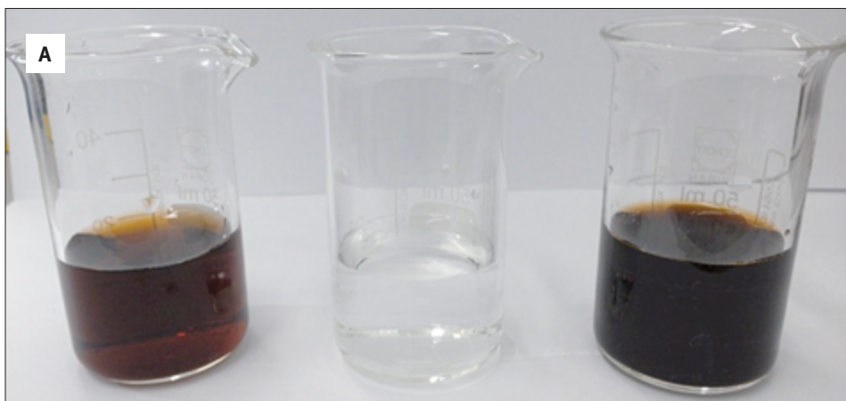
Abb. 9: A. Proben aus der Umkehrosmose (UO) am Standort der DEK Berlin, Zulauf (links), Permeat (mitte), Konzentrat (rechts); B. Rückgewonnenes Salz aus dem UO-Konzentrat nach der Kristallisation am Ende der Konzentratbehandlung (Fotos: TU Berlin)
